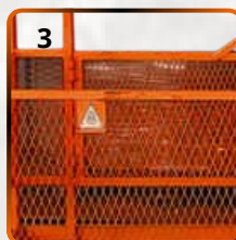
4 Piso y laterales en metal desplegado
